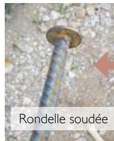
4. Souder une rondelle plate à l'une des extrémités des barres d'armature (9,5 mm (3/8")). Fabriquer des tiges de longueurs variées, majoritairement 10 cm (4") plus longues que les tubes carrés, mais aussi de 20 et 50 cm (8 et 20") de plus. Elles seront utiles dans les cours d'eau ayant un lit accidenté (non régulier);
